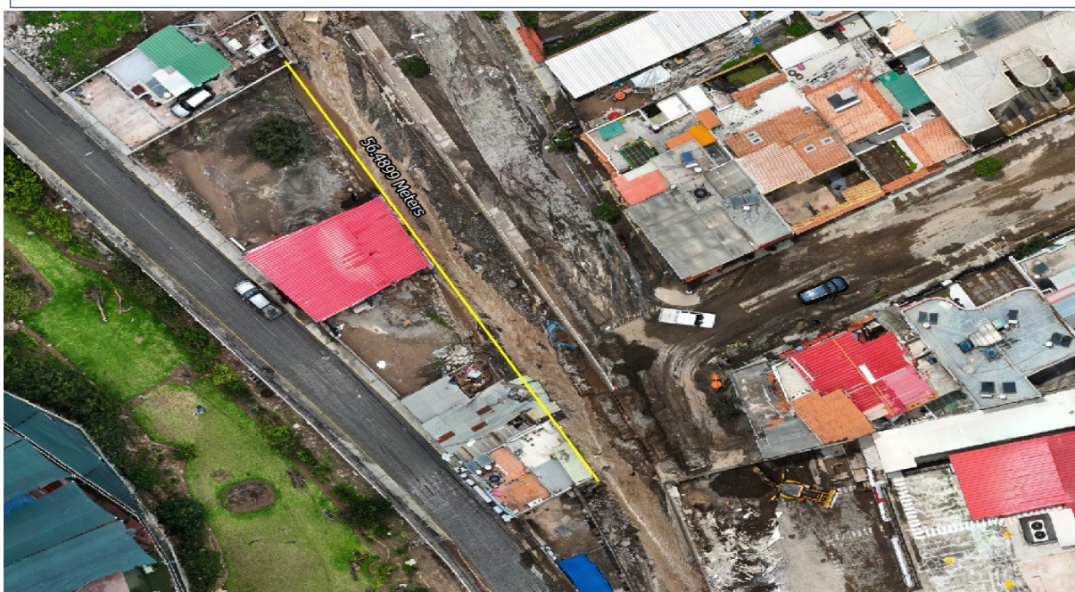
IMAGEN 02: EN ESTE TRAMO, LA VISTA DE PLANTA REALIZADA CON DRON, SE OBSERVA LOS DAÑOS QUE HA OCASIONADO LA CRECIDA DE LA QUEBRADA CHULLO, SOCAVANDO SU MARGEN DERECHA, AFECTANDO A LAS VIVIENDAS CERCANAS Y SU CAJA HIDRÁULICA SE ENCUENTRA COLMATADO DE SEMIENTOS.
