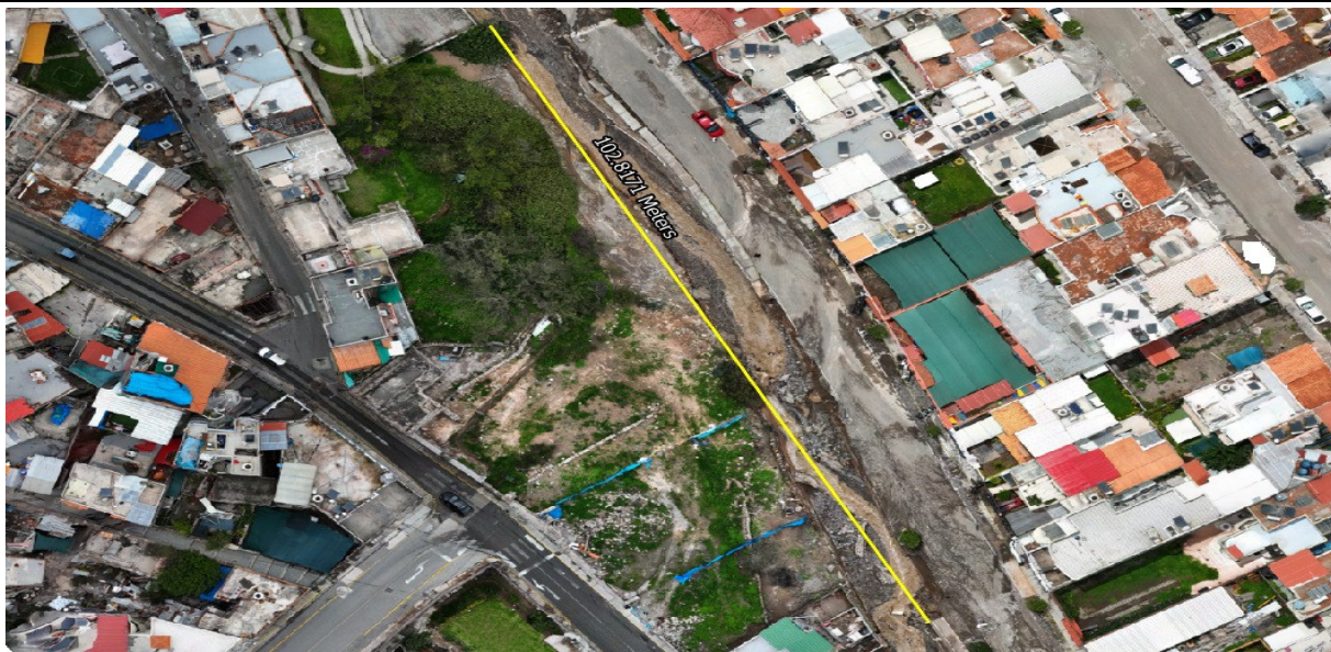
IMAGEN 01: EN ESTE TRAMO, LA VISTA DE PLANTA REALIZADA CON DRON, SE OBSERVA LOS DAÑOS QUE HA OCASIONADO LA CRECIDA DE LA QUEBRADA CHULLO, SOCAVANDO SU MARGEN DERECHA, AFECTANDO A LAS VIVIENDAS CERCANAS Y SU CAJA HIDRÁULICA SE ENCUENTRA COLMATADO DE SEMIENTOS.
