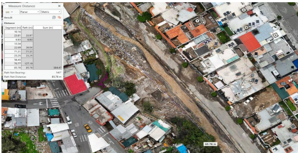
IMAGEN 03: EN ESTE TRAMO, LA VISTA DE PLANTA REALIZADA CON DRON, SE OBSERVA LOS DAÑOS QUE HA OCASIONADO LA CRECIDA DE LA QUEBRADA CHULLO, SOCAVANDO SU MARGEN DERECHA, AFECTANDO A LAS VIVIENDAS CERCANAS Y SU CAJA HIDRÁULICA SE ENCUENTRA COLMATADO DE SEMIENTOS.
